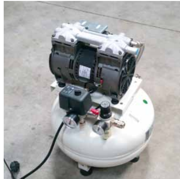
Manomètre de pression du réservoir et manomètre de pression de sortie.
