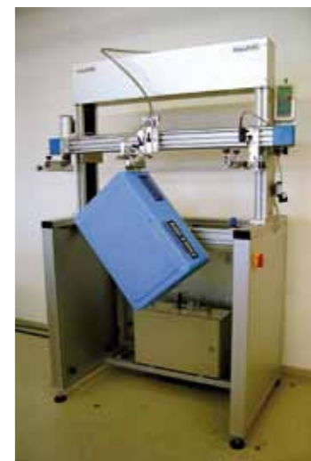
RP 2.2 BOX Machine spéciale pour l'impression de cagettes sur 2 faces.
